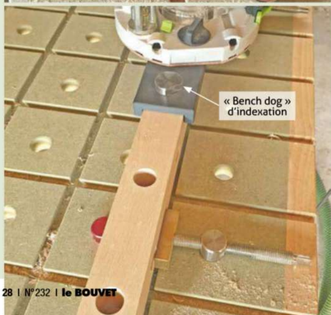
Pion / butée de référence pour positionner les premiers fraisages
