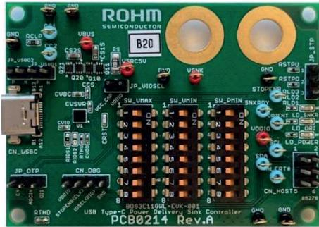
**Figure 12** : les périphériques récepteurs USB-PD peuvent être implémentés avec des chipsets comme le Rohm BD93E11GWL et testés sur leur carte d'évaluation (Source : [https://www.mouser.de/images/rohmsemiconductor/lrg/BD93E11GWL-EVK-001\\_DSL.jpg](https://www.mouser.de/images/rohmsemiconductor/lrg/BD93E11GWL-EVK-001_DSL.jpg))
